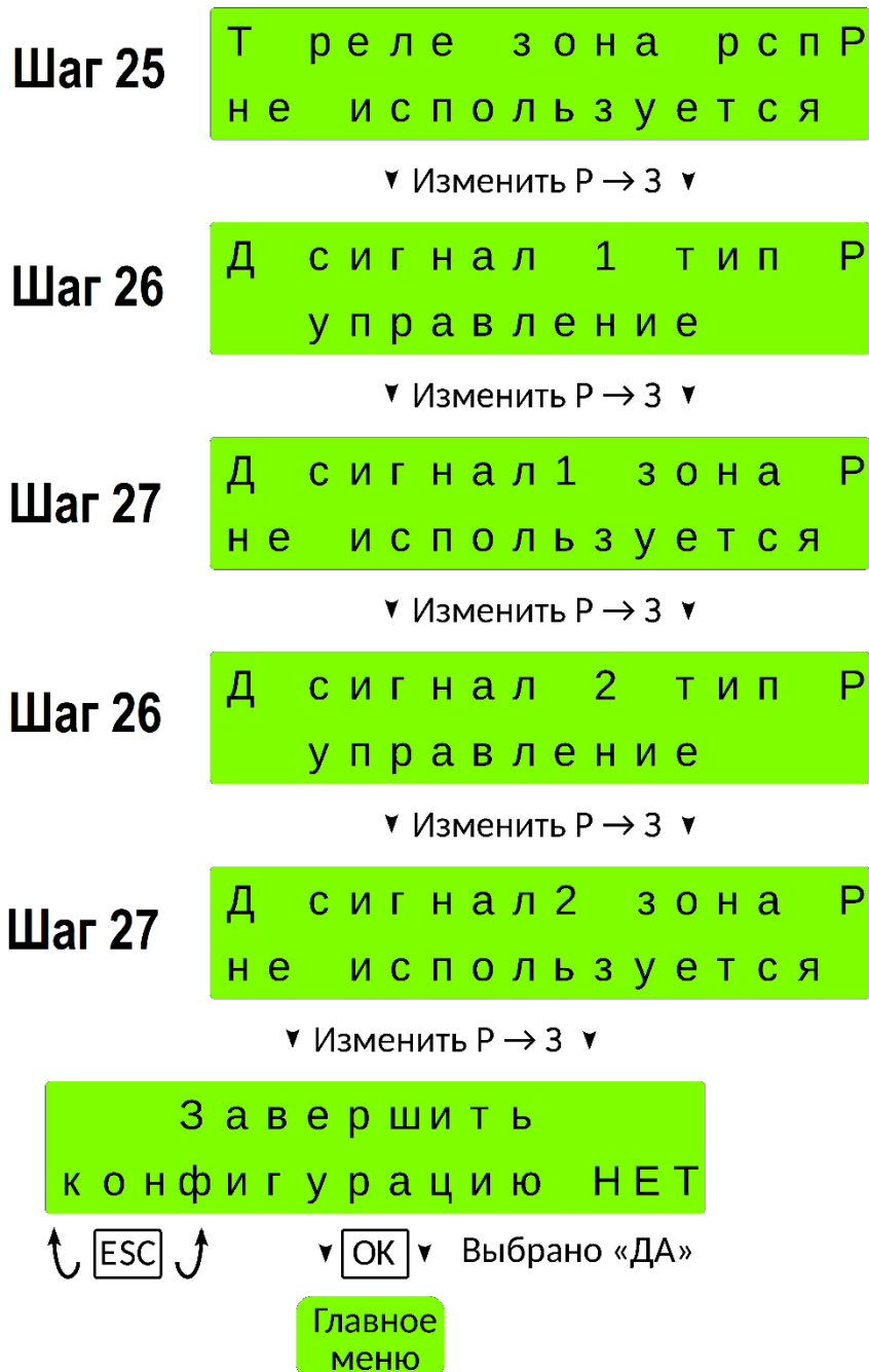
Рисунок 30 – Конфигурирование ЩА TИPROmatic 200.10 (шаги 25...27)
